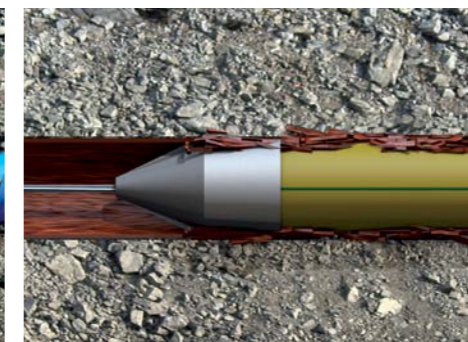
Протягивание через старую трубу с ее разрушением
