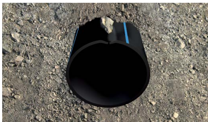
Повреждение в результате точечной нагрузки на стандартной трубе PE100 или PE80
