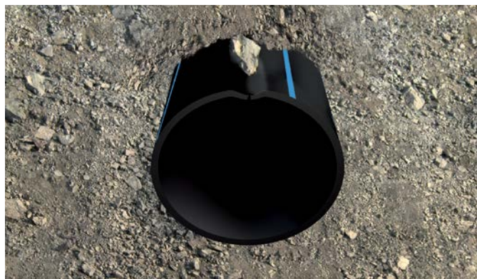
PE100 ar PE80 vamzdžių taškinių pažeidimų pavyzdys
