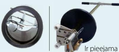
Paredzēts izmantošanai montāžas laikā, cauruļu metinājuma vietā iekšējās metinājuma šuves nogriešanai (noņemšanai) no pamatcaurules sieniņas iekšējās virsmas, kas tika veikta ar kausēšanas veidu HS (cauruļu savienojuma vietu metināšanai sadurā).
