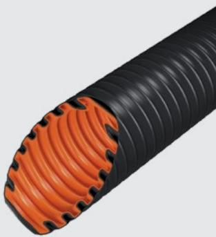
Гибкая труба для электротехнических инсталляций из специального, безгалогенного материала оптимально применима для прокладки кабелей вне помещений в местах, подверженных прямому воздействию ультрафиолетовых лучей. Труба снабжена оболочкой из пластифицированного материала, специально модифицированного для обеспечения стойкости к воздействию ультрафиолетового излучения.
